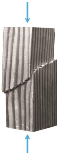
图 1 受压缩失效的木材块体
